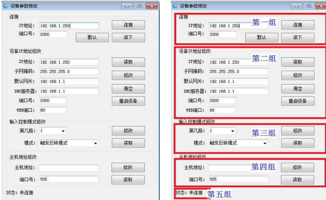
1：连接，2：设备 IP 地址修改，3：输入控制模式修改，4：主机地址修改，5：状态
