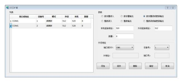
扩展更多数量,可成为 32 路控制器,全部支持 TCP 的状态实时反馈,扩展数量时和面板双联可控制。在此扩展标装 Modbus-RTU 协义,环境监控等设备,提供给上位机 TCP 读取状态。
