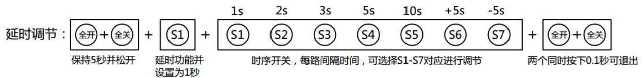
通过最右侧（全开）（全关）两个按键同时按下，并保持5秒以上后松开即可，然后选择 表示设置（时序延时功能），此时已经按中了 ，延时时间直接设为1秒，可以通过按键S1到S7进行选择合适的时间，或增加5秒，和减少5秒方法，设置时间时，没有数字表，凭感觉自行操作。设定好需要的时间后，再同时按下 即可退出。当S1和S7按键无动作，也没有双键同时按下退出时，超过20秒后，电源控制器也将自动保存，并自动退出。
