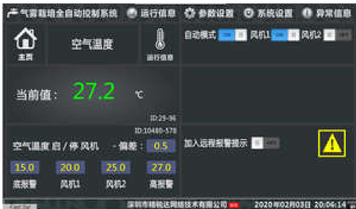
空气温度监控，调节通风降温系统自动控制
