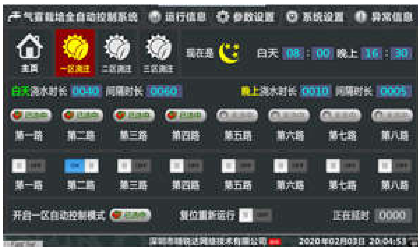
浇注系统，可对小型 4 组阀，或中型 24 路阀进行定时循环浇注
