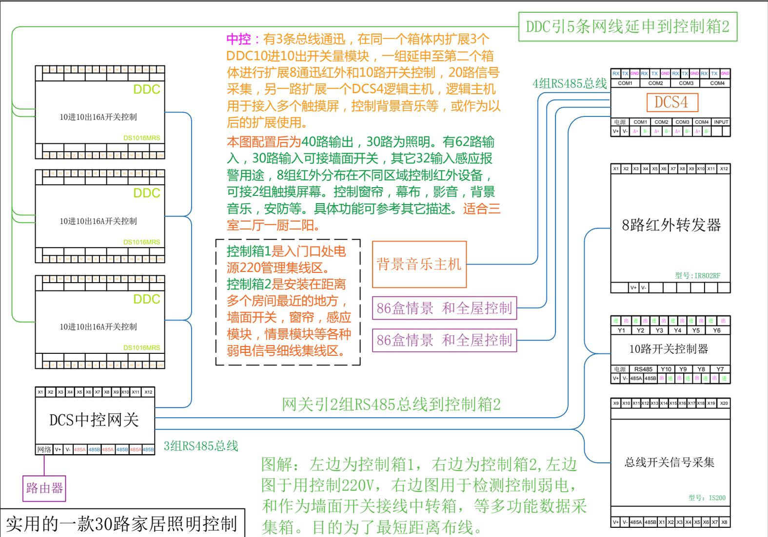
**中控：**有3条总线通讯，在同一个箱体内扩展3个DDC10进10出开关量模块，一组延申至第二个箱体进行扩展8通讯红外和10路开关控制，20路信号采集，另一路扩展一个DCS4逻辑主机，逻辑主机用于接入多个触摸屏，控制背景音乐等，或作为以后的扩展使用。
