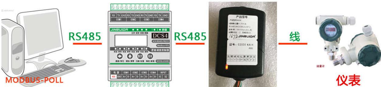
现在中控已经不断的通过 RS485 去读取模拟量采集模块了，中控还有 3 个 RS485 通讯口，我们取其中一个通讯口 B,C,D 均可以，然后通过 USB 转 RS485 模块，再用 Modbus-Poll 读取一下数据。按照下图，重新打开软件，电脑 RS485 连接中控某一个通讯口，并按顺序操作 2 步读取中控模拟量：
