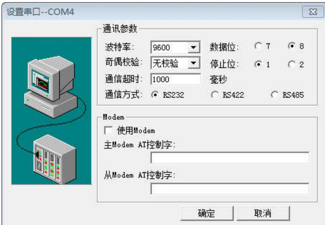
根据上图设置 9600，8，无效验，1，1000，即可完成模块添加的操作，后面对界面和变量操作。
