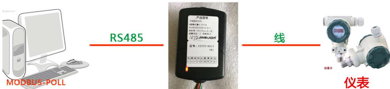
根据上图连接模式为：**Modbus-Poll 软件-模拟量采集模块-仪表模块(电流发生器)**，测试模拟量采集模块。
