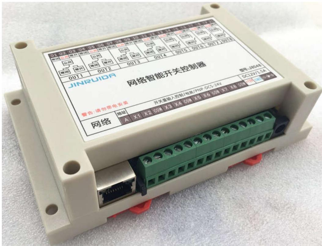
型号 J8048 是一款通过网络方式，使用客户端软件在 PC 端、APP 手机端、组态软件或中控，通过局域网或广域网进行连接，远程控制 8 路继电器开关带动负载，控制器内置了 8 个独立的继电器开关，8 路开关可分别控制不同电压，或集中控制相同电压，控制器同时具备 8 个信号输入，用于检测信号，和增加手动功能，逻辑编程。控制器内置实时时钟，内置电池，可以通过 PC 客户端软件预约固定时间自动开关功能，内置每路 AC220V/10A 继电器，可以控制灯光照明，或控制交流接触器来增加大功率负载，或控制三相电气设备。本控制器除了提供客户端软件直接使用，还提供了大量二次开发组件，供系统集成。
