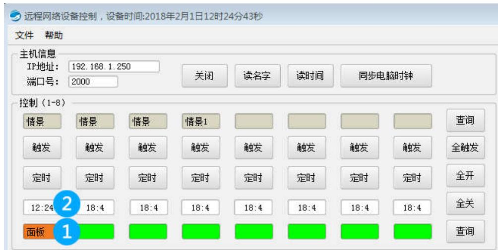
上图标号 1 号为信号输入 X 的显示开关态，当有输入时显示橙色，无输入时显示绿色，上图标号 2 号是检测输入 X 的最后一次的检测时间，这个必须软件正在打开并正在连接时才能检测到输入最后一次时间，这些时间保留最后一次，没有长期的记录，也没有特别用途。
