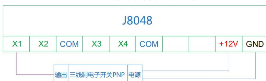
当采用电子式输出 5-24V 传感器 PNP 型的开关，接线方式如上图。必须采用 PNP 型电子式三线制传感器，传感器可能是接近开关，光电开关等，工作电源必须与控制器是同一个电源适配器或开关电源供电的，传感器输出信号接入 X 端，PNP 表示输出电源正极，NPN 表示输出电源负极，我们只选用 PNP 型输出电源正极的这种，采用这种类型的传感器开关时，控制器输入端 4 个公共端 COM 口可以留空不用
