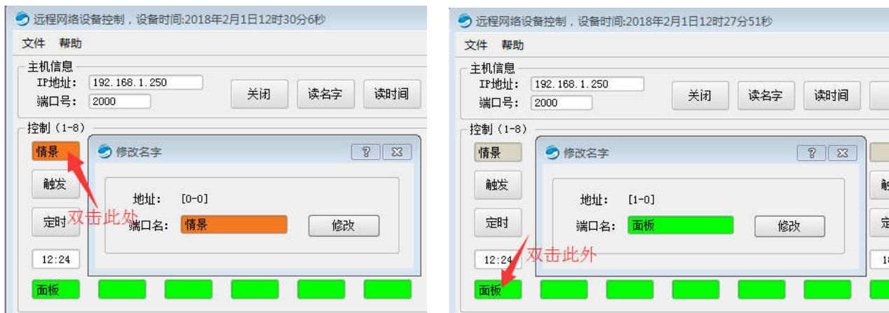
【上图左】为输出端每一路的改名方法，【上图右】为输入端 X 的改名方法，点修改后，将名称保存在芯片内存，对控制器断电、复位出厂等各种方式都不会自动清除，只能通过再次修改才能改变。
