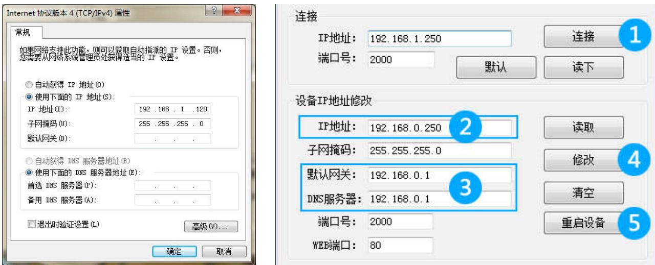
想办法用电脑的网卡与控制器直连，不需要经过路由器，交换机等，需要将 WIFI 进行禁用，是禁用，然后手动分配一个 IP 地址给本地网络，使电脑的 IP 地址的网关在 192.168.1.1，这样就与控制器保持在同一网关内，电脑就可以与控制器直接，能连接才可以给控制器修改分配新的 IP 地址。
