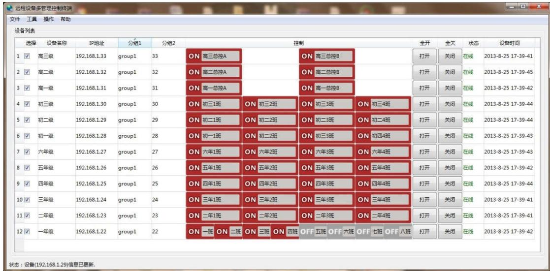
提供批量集中管理操作监控软件,在PC电脑端安装本套集中管理软件同时连接管理1-500台控制器,批量或独立操作每一台到每一个节点的开关控制,实时显示设备在线工作情况,批量设置定时功能,一键全开全关,批量对所有设备写入预设的工作时间,预设的定时开关等功能。
